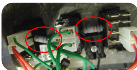
1 resistor de 220 OHMS entre cada botão
