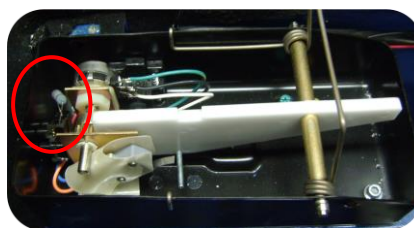
1 resistor 220 OHMS no pedal do acelerador(3)
